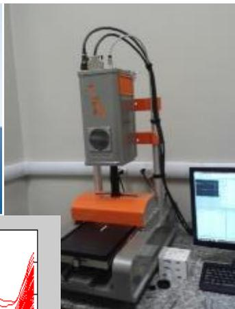
... à un autre appareil caméra HSI, SPECIM sur des images de disques de bois solide.
