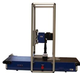
Les images hyperspectrales ont été acquises en absorbance avec un système d'imagerie de type « pushbroom » (BurgerMetrics, SIA, Riga, Lettonie) couvrant la gamme spectrale de 950-2500nm avec une résolution spectrale de 7 nm. Leur taille finale est de 231x318x212 pixels (champ de vision de 8.2x6mm, avec une résolution spatiale de 26µm).
