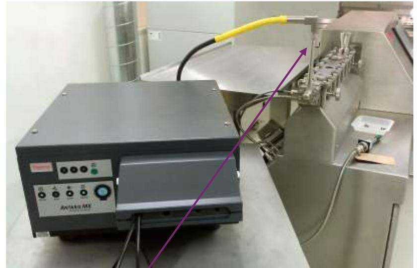
Sonde interfacée à un port de sortie standard
